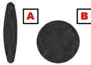
Abb. 5: Normales Sprühbild: Flachstrahl (A) und Rundstrahl (B)
