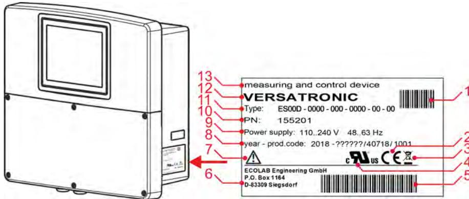
Abb. 1: Typenschild auf Gerätegehäuse
