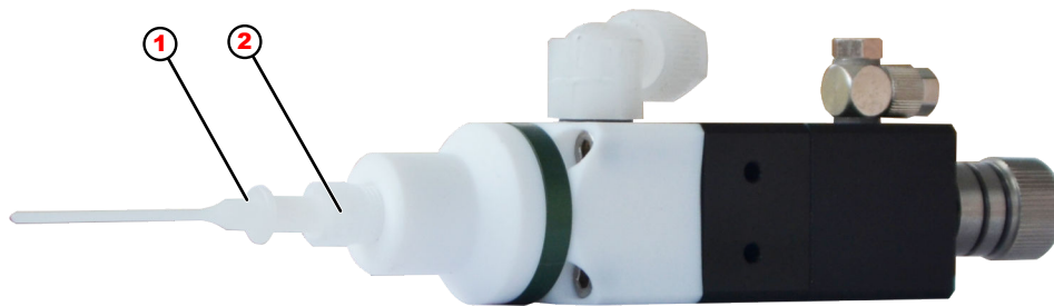
Fig. 3 : Raccord de dosage avec embout de dosage (figure donnée à titre d'exemple)
