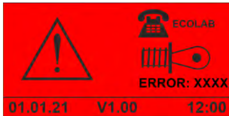
Fig. 22 : Indication « Erreur de la cellule de mesure »
