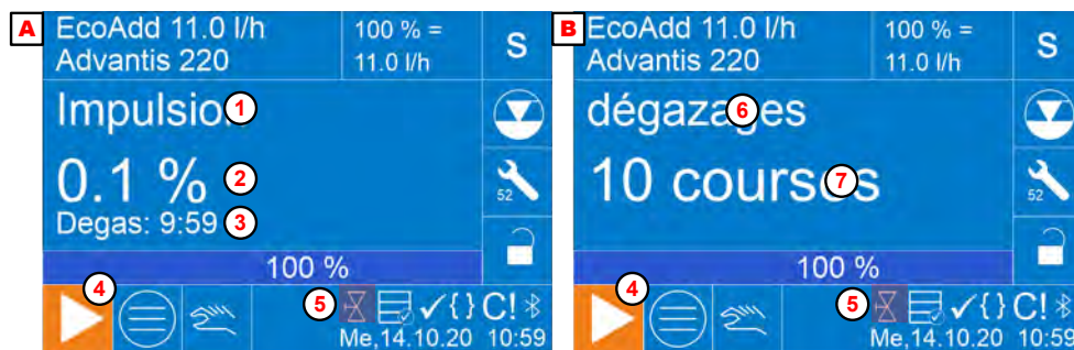
Fig. 6 : Processus de dégazage et de purge
