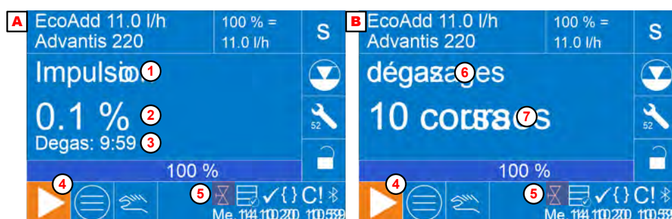
Fig. 6: Processo di degasaggio e ventilazione
