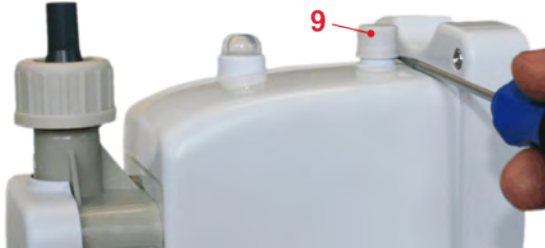
Abb. 8: Lösen der Abdeckkappe zur Drehzahlverstellung am Potentiometer
