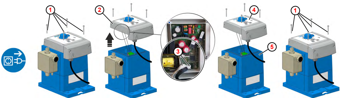
Fig. 18: Sustituir la unidad de control
