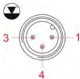
Abb. 7.14 Anschlussbelegung Steckplatz I (3-polig), Eingang für Niveauvorwarnung und Leermeldung
