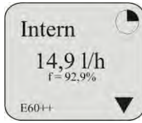
Abb. 10.30 Displayanzeige in der Betriebsebene bei aktiviertem Dosierregler
