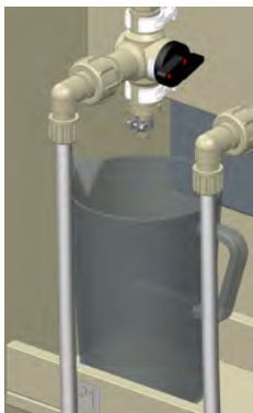
Fig. 18 : Mise en service – étalonnage
