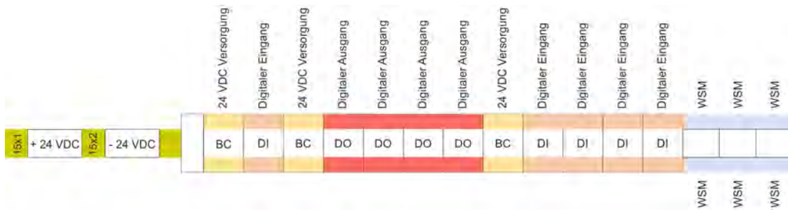
Abb. 11: Zuordnung I/O-Module und Pilotventilblock
