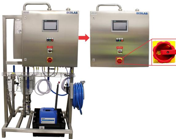
Der Not-AUS-Schalter sitzt an der Tür des Steuerpults direkt unter dem USV-Leistungsschalter.
