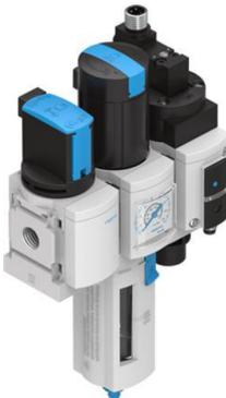
Die Drucklufteinheit versorgt die Anlage mit Druckluft.
