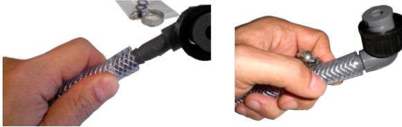
4. Schraube der Schlauchschelle anziehen.
