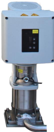
E-Pumpen von Grundfos sind mit frequenzgeregelten Permanentmagnetmotoren für den ein- oder dreiphasigen Netzanschluss ausgerüstet. Die Pumpen verfügen über einen PI-Regler und können für einen externen Sensor konfiguriert werden, der die Regelung der folgenden Parameter ermöglicht:
