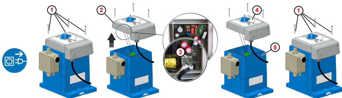
Fig. 18 : Remplacement de l'unité de commande
