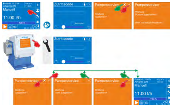
Abb. 23: Pumpe in den Wartungsmodus versetzen, wenn ein Zutrittscode verwendet wird
