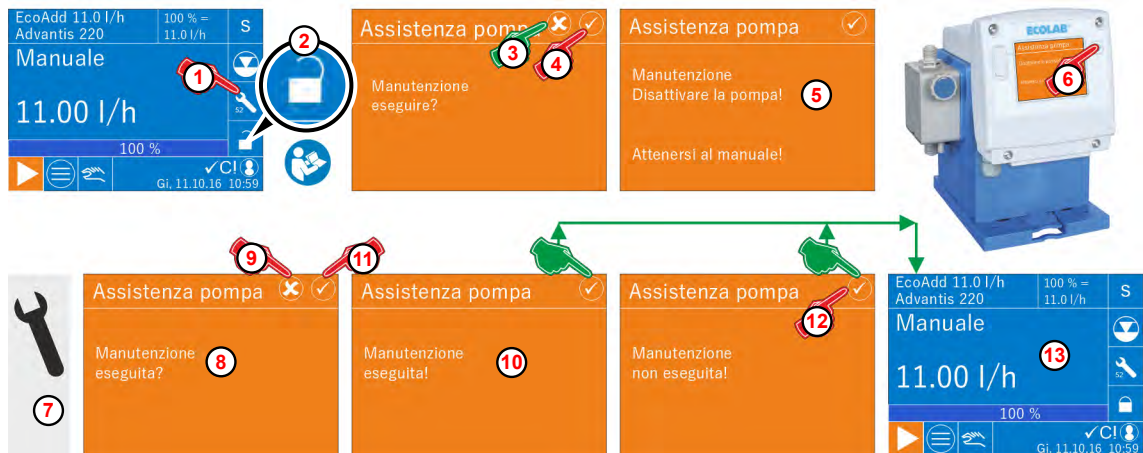
Fig. 98: EcoAdd portare alla modalità di manutenzione, se viene utilizzato nessun codice di accesso
