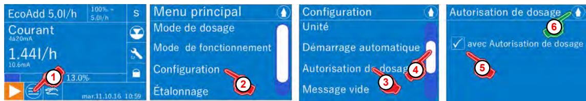
Fig. 8 : Activation de l'[Autorisation de dosage]
