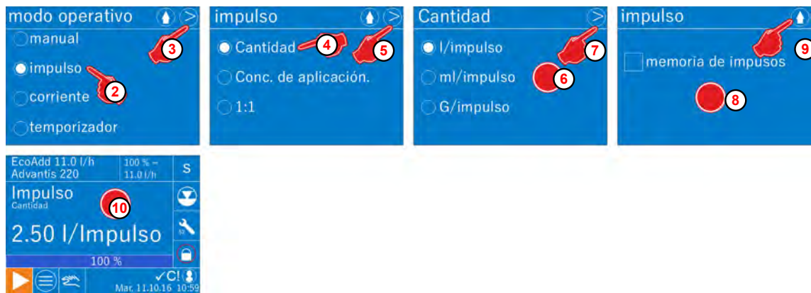
Fig. 37: [Modo de funcionamiento]: [Impulso] [Cantidad]
