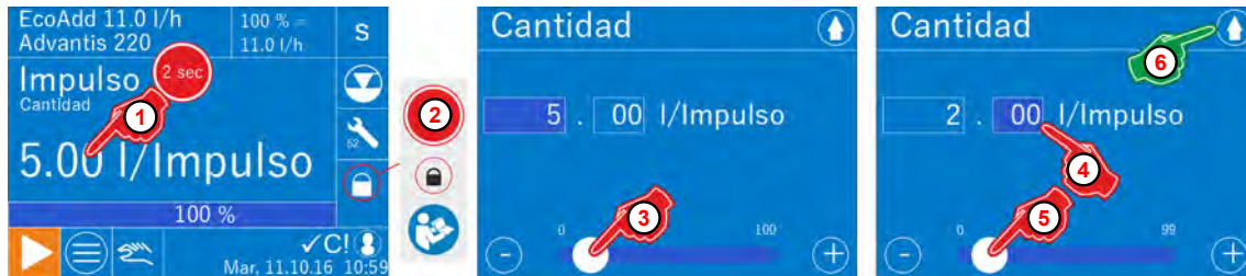
Fig. 38: [Cambiar Impulso] [Cantidad] en el nivel de funcionamiento
