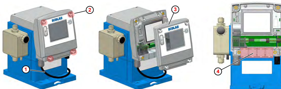
Fig. 21: Installazione elettrica «EcoAdd»
