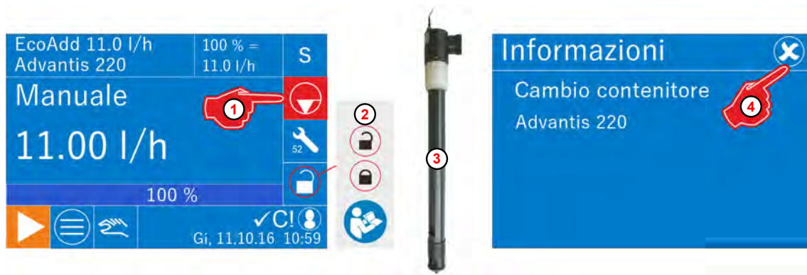
Fig. 95: Messaggio vuoto: Effettuare il cambio contenitore
