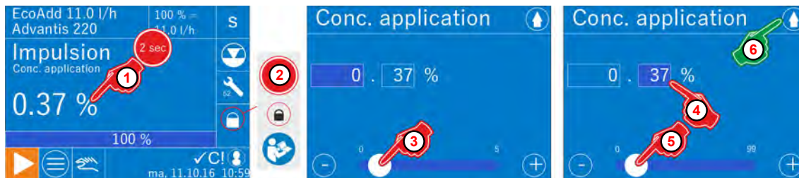
Fig. 40 : Modification du réglage [Impulsion] [Concentration] [%] au niveau opérationnel
