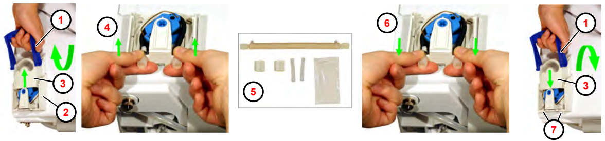
Fig. 25: Sostituzione tubo schiacciato
