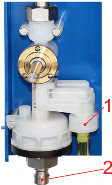
Abb. 10: Injektor mit Saugleitungsanschlüssen
