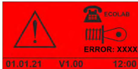
Fig. 26 : Indication « Erreur de la cellule de mesure »
