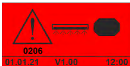
Fig. 19 : Code d'erreur 206 (produit de rinçage APEX)
