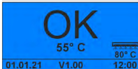
Fig. 9 : Écran de base avec la température de lavage
