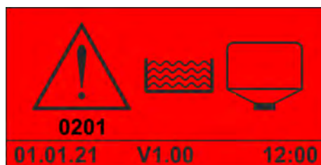
Fig. 13 : Code d'erreur 201 (produit solide)
