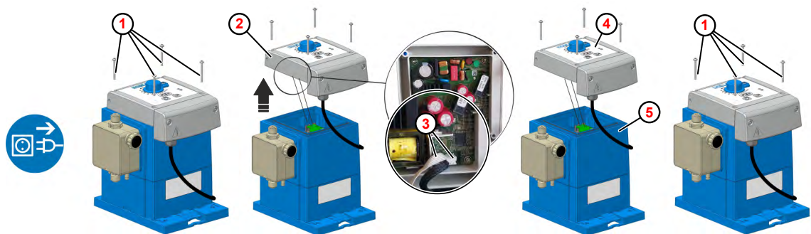
Fig. 18: Sustituir la unidad de control
