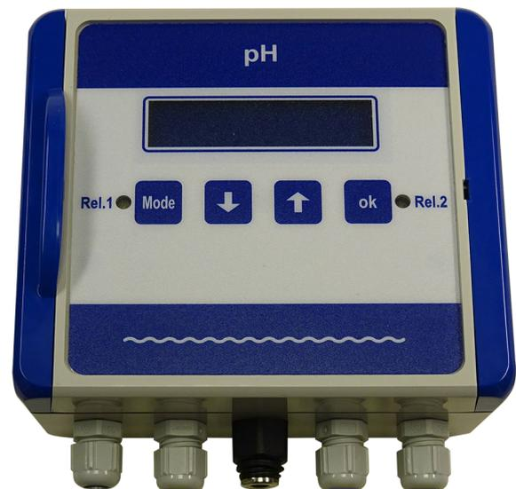
Der Messtransmitter EcoTrans II erfasst Messwerte im Bereich zwischen pH 0 und 14 und wandelt diese in ein Normsignal 4 - 20 mA um (pH 0 = 4 mA, pH 14 = 20 mA). Der aktuelle Messwert wird über ein LC-Display angezeigt.
